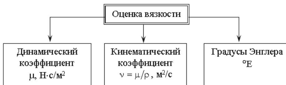
Рисунок 1.7 - Способы оценки вязкости жидкости
